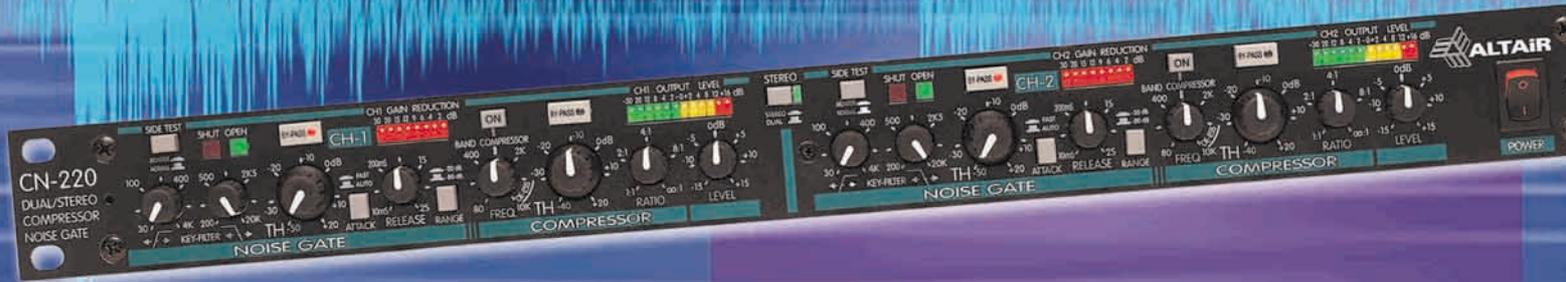
La unidad Altair CN-220 incorpora en 1U de rack dos canales independientes para funcionamiento en modo Dual. La función Estéreo permite controlar de forma dependiente, los parámetros de ambos canales desde el canal CH-1 permitiendo un control de la dinámica equilibrado sin pérdida de la imagen Estéreo. Cada canal incorpora una puerta de ruido Noise Gate previa a un compresor/limitador.
