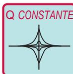
**Q CONSTANTE:** La topología empleada de Q constante, asegura mínima interacción entre bandas e independiza el ancho de banda de cada filtro de la ganancia/atenuación efectuada.
