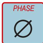
**PHASE:** Ajuste de fase entre vías de 0° a 360°. En la vía de subgraves permite alinear desde el panel frontal desfasajes de hasta 6 ms. (2 metros) con respecto a la vía de graves
