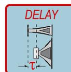
**DELAY:** Cuando las diferencias de fase son muy grandes e irregulares, el empleo del retardo por vía es la única herramienta para obtener coherencia de fase entre los componentes arrays
